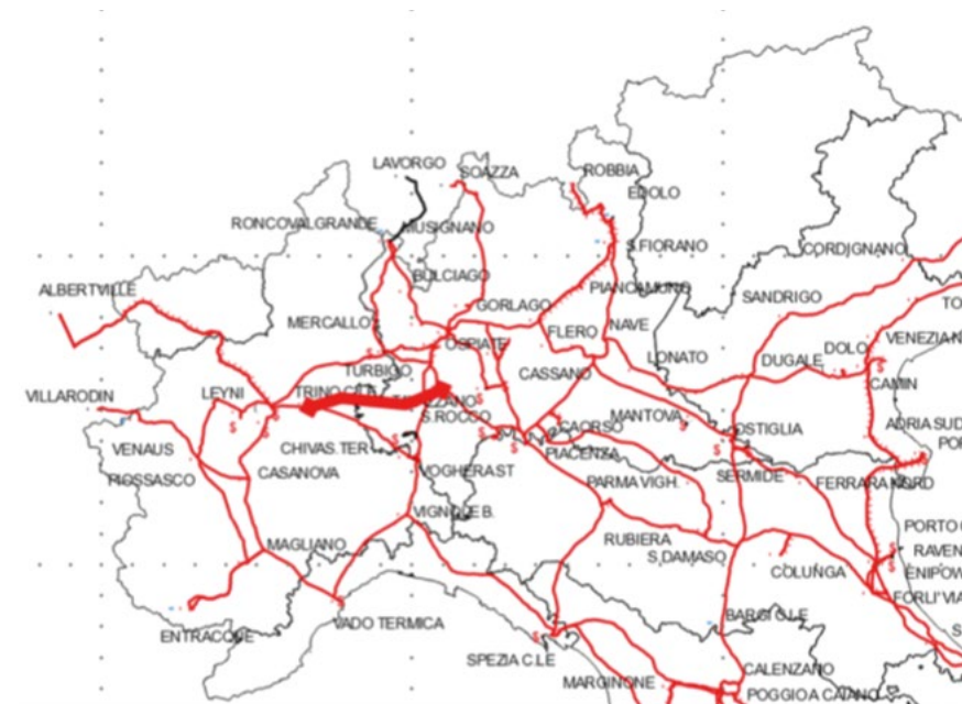
Razionalizzazione della rete Piemonte - Lombardia a 220/132 kV
